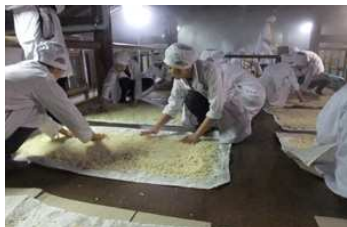
小仕込みタンクに床で放冷し十分に冷やした蒸し米を入れる。榿入れ作業で十分にかき混ぜる・・・米が榿に絡みつき重い・・・見た目よりも重労働。蔵人はすごい！
