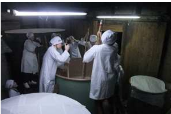
小仕込みタンクに床で放冷し十分に冷やした蒸し米を入れる。榿入れ作業で十分にかき混ぜる・・・米が榿に絡みつき重い・・・見た目よりも重労働。蔵人はすごい！
